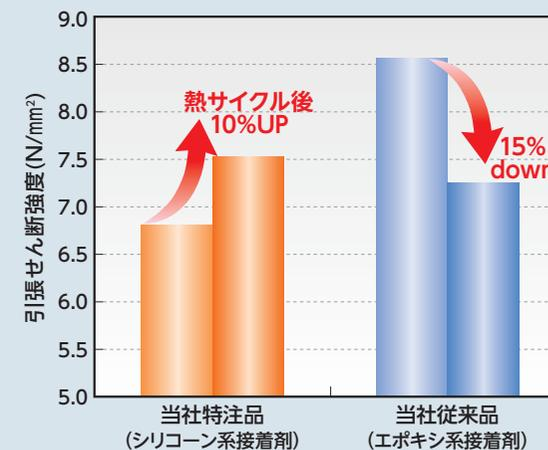
当品はシリコン接着剤を用いているので、熱サイクル耐久性試験を行うと接着強度が向上します。
